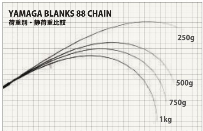
YB88チェインに250g刻みで4段階に荷重を掛けた曲がり比較です。低荷重から荷重が増えた段階で曲がりが大きく変化しています。本文中の可変ダブルテーパーデザインでも触れていますが、この曲がりが大きくなつ瞬間に大きな反発力が生まれています。静荷重の曲がりが大きいほど反発力も増すと考えてください。
