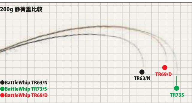
● ティップランエギング用バトルウィップTRの各種曲がり比較です。TR63/Nは目感度と操作性に特化したモデルであり、使用感で言えば最もプランクの張りの強さを感じます。タフな状況下での繊細なアタリを拾て行く際に大きなアドバンテージとなる高レスポンスモデルになっています。TR73/SはTRシリーズの中で最もレンズが長く、またソリッドティップ部分も長めに設計しており、アタリを取る際に波の影響を受けにくいモデルになっています。3機種中ではマイルドな使用感です。TR69/Dは深場・潮流場用のパワー型ですが、使用感は決してハイではありません。深場に限らず、標準より重めのエギを使用し、速いフォールでスピード感を持った攻撃が求められる展開にもオススメです。
