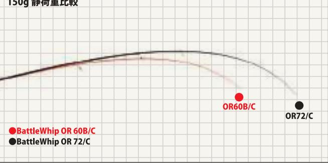
● BattleWhip ORの2機種にロッドの角度をほぼ水平にした状態で、150g(40号)の静荷重を掛けた状態の曲がり比較です。OR60B/Cは、バーチカルで50~60号のシンカーの使用を視野に入れており、バット部は40号の鉛負荷に対してキャストと操作が快適に行える十分な余力を残しています。目感度でもアタリが取れるようティップの張りを落としてあるものの、チューブラーの高感度でアタリや違和感が解りやすくするために、ティップ部の張りを落とし、40号のリグをキャストして操作するための強い張りを持たせたベリーとバットが特徴です。
