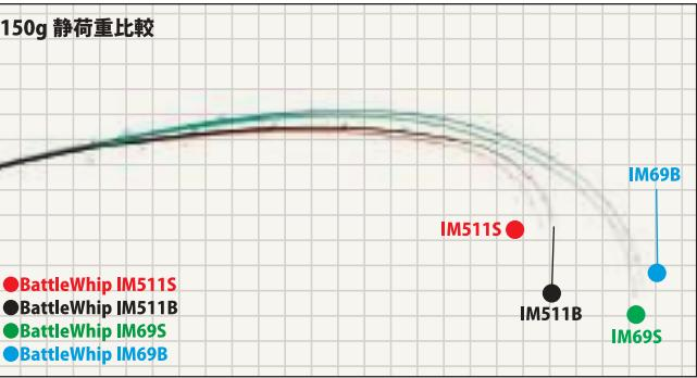
● BattleWhip IMの4機種にロッドの角度をほぼ水平にした状態で、150g(40号)の静荷重を掛けた状態の曲がり比較です。IM69S&Bはティップの曲がり幅が大きいことにより、小さなアタリでもティップが大きなアタリに変換してくれる目感度の高さが特徴となります。511S&Bは、高レスポンスな操作性と積極的に掛けにくスタイルに特化したモデルとなります。そのため曲がり幅を少なくすることにより、操作性を向上させると同時にアタリを手元までダイレクトに伝える目感度の高さが特徴です。アングラー側がフッキングまでの反応スピードが速まりますので、「掛けの楽しさ」を倍増してくれるモデルです。
