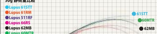
●ルーパス・エリアトラウトシリーズに50gの静荷重を掛けた状態での曲がり比較です。ロッドパワーではなく調子を確認する比較としてご覧ください。追加モデルとなる61STTは、引き抵抗の強いミノの使用を想定しているため、ロッド全体に張りを持たせたシャープな使用感となっています。
