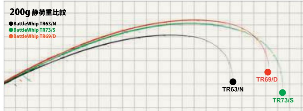
●ティップランエギング用バトルウィップTRの各種曲がり比較です。左図が3機種を比較したもので、他は機種別に50g/100g/200gの静荷重を掛けた場合の曲がり変化を表示しています。
