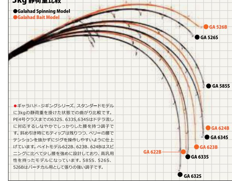
● ギャラハド・ジギングシリーズ、スタンダードモデルに3kgの静荷重を掛けた状態での曲がり比較です。PE4号クラスまでの632S、633S、634Sはドテラ流しに対応するしなやかでしっかりした腰を持つ調子です。斜め弓き時にティップは残りつつ、ベリーの腰でテンションを抜きずにジグを操作しやすいように仕上げています。ベイトモデル622B、623B、624Bはスピニングに比べて少し腰を強めに設計しており、高汎用性を持ったモデルになっています。585S、526S、526Bはバーチカル用として張りの強い調子です。
