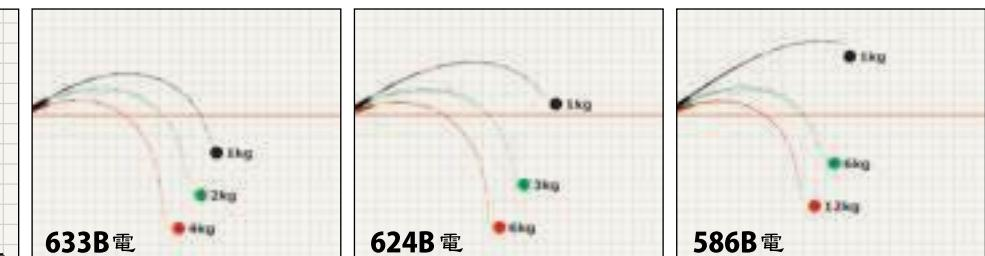
上はギャラハド電動ジギングモデル機種別に3種類の荷重を掛けた状態の竿曲がりです。
