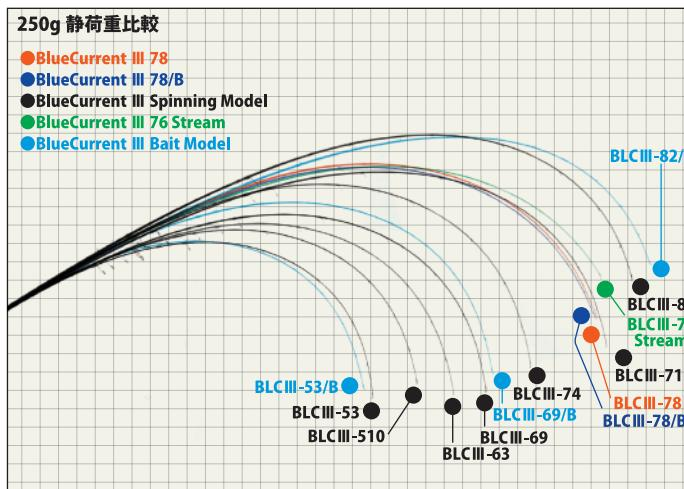
●2024年に追加される「78&78/B」は、ボトム攻略に特化したモデルであり、単にロッドの硬さだけでなく、反発力にもこだわった設計となっています。この新しいモデルの登場により、ブルーカレントIIIシリーズはアングラーの意図に応じて、より自由に楽しめるラインナップが完成しました。
