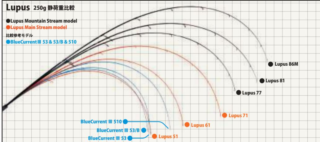
●トラウトモデルであるルーバスシリーズに250gの静荷重を掛けた曲がり比較です。参考にブルーカレントの渓流対応モデルである53と53/B、510も比較しています。ブルーカレントの中でもこの3機種はミノーのトゥイッチングをしやすい調子ですが、ミノーイングに特化したルーバスとは違います。渓流のミノーイングに関しては負荷が掛かった状態での反発力も使用感に大きく影響するため、曲がり比較が全てを表している訳ではありません。その点をご理解の上、曲がり比較を参考にしてください。
