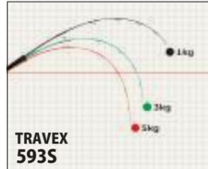
上はギアラハド・トラベックス2ピースモデル機種別に3種類の荷重を掛けた状態の 曲がりです。1kgは共通ですが、更に上の荷重はロッドのパワー別に変えてあります。
