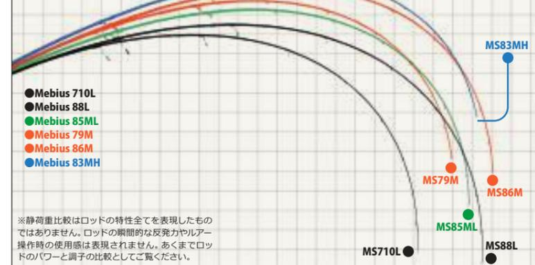
エギングロッドシリーズ・メビウスに500gの静荷重を掛けた曲がり比較です。リールをセットした状態で負荷を掛けています。メビウスシリーズはティップを柔軟にした設計になっており、扱いやすさと汎用性を高めたモデルです。重視したのはキャストバリエーションであり、リリースポイントを広く設定して、軽力で投げても、足場の不安定な場所で投げても安定した飛距離を出せるように調整しました。バランスの良いキャストフィールと共に、エギングの様々なアクションやデカイカに対応する強度を持たせています。その汎用性の高いブランク特性は、幅広いターゲットも狙える多目的ロッドの側面も持っています。設定としてはエギングだけでなく、アジ・メバルからクロダイ・シーバス、ライトショアジギングやロックフィッシュ狙いも楽しめます。自由なスタイルでメビウスのポテンシャルを探ってみてください。
