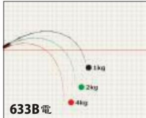
上はギアラハド電動ジギングモデル機種別に3種類の荷重を掛けた状態の 曲がりです。1kgは共通ですが、更に上の荷重はロッドのパワー別に変えてあります。
