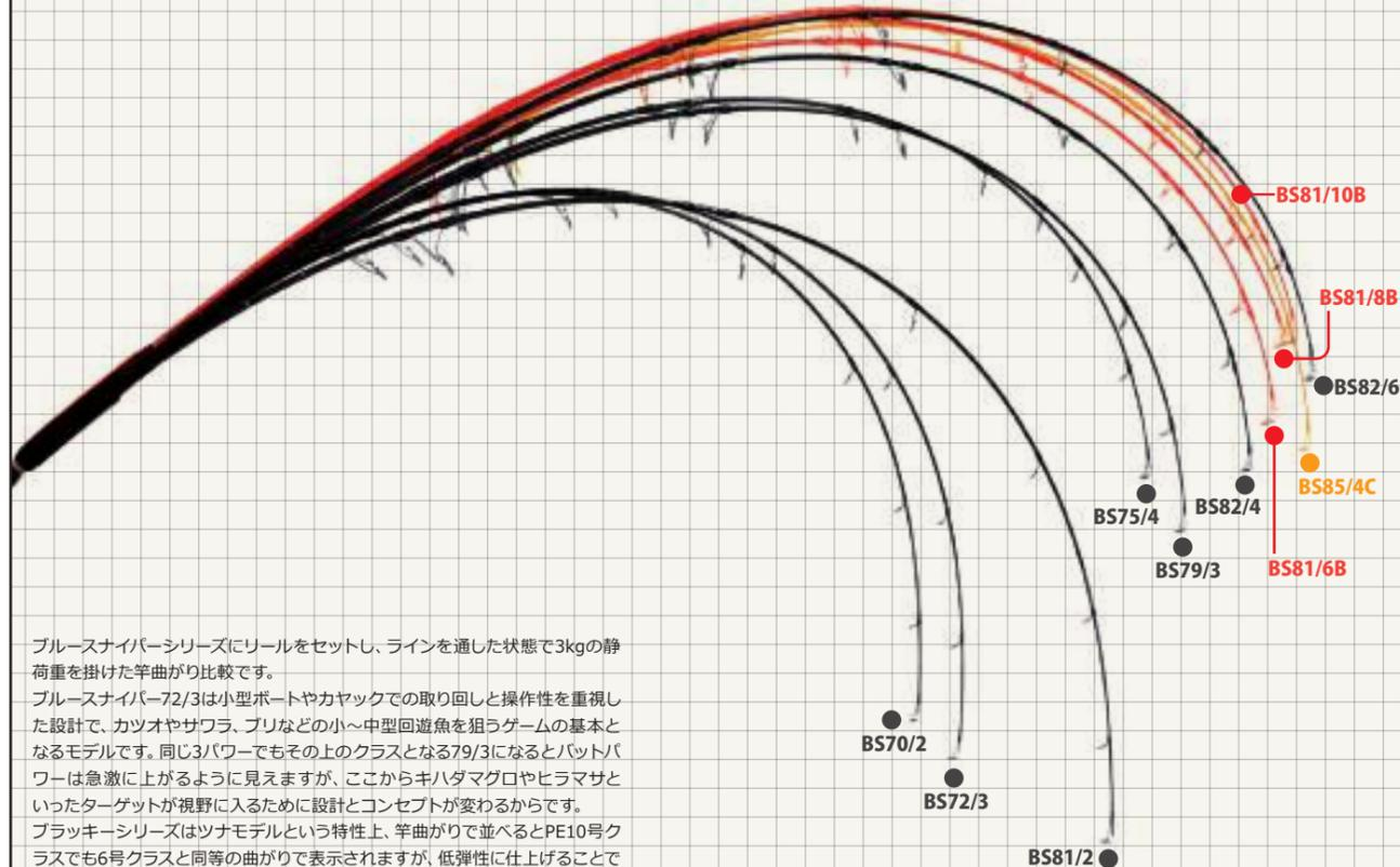
ブルースナイパーシリーズにリールをセットし、ラインを通した状態で3kgの静荷重を掛けた竿曲がり比較です。ブルースナイパー72/3は小型ボートやカヤックでの取り回しと操作性を重視した設計で、カツオやサワラ、ブリなどの小~中型回遊魚を狙うゲームの基本となるモデルです。同じ3パワーでもその上のクラスとなる79/3になるとバットパワーは急激に上がるように見えますが、ここからキハダマグロやヒラマサといったターゲットが視野に入るために設計とコンセプトが変わるからです。ブラックーシリーズはツナモデルという特性上、竿曲がりでは並べるとPE10号クラスでも6号クラスと同等の曲がりて表示されますが、低弾性に仕上げることでアングラーに優しく、大型魚には一定の負荷を与え続けやすいロッドになっており、竿を起こして角度をつけることで、その強靱なバットパワーを発揮するという特殊な調子となっています。
