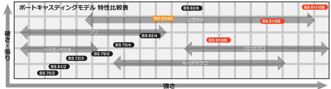
ボートキャストモデルはメインに使用するルアー、ファイトスタイルによってロッド特性が変わります。例えば、マグロ系の魚は大きくなるほど持久戦になりやすいのでアングラーの負担を軽減するように張りを落とし、ヒラマサゲームなど誘い出しがメインのゲームはキャスト性能とパワーのバランスを重視した設計になっています。
