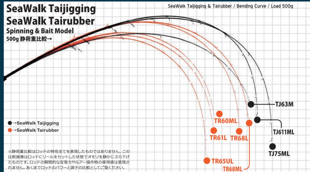
シーウォーク・タイジギング&タイラバシリーズにリールをセットし、ラインを通した状態で500gの静荷重を掛けた竿曲がり比較です。タイジギングモデル3機種の内、63Mのみ1ピース構造の為、比較した場合に曲がり方が異なります。この画像で見るとバット自体は弱く見えますが、1ピースのロッド全体で曲がるように仕上げた大物竿です。また水深50m以内ならば75ML、水深50mを超える場合は611MLが扱いやすいシチュエーションです。タイラバモデル68L,68MLはグリップジョイントの2ピース構造となり他3機種とはバットパワーは大きく異なります。深場・潮流場用に開発されたモデルであり、高負荷な中でタイラバをリールで巻き取る際に曲がりすぎて感度を失うことはありません。タイラバも100g以上のヘビーウェイトを多用し、水深も50m以上をメインに狙う方にもお勧めの2機種です。
