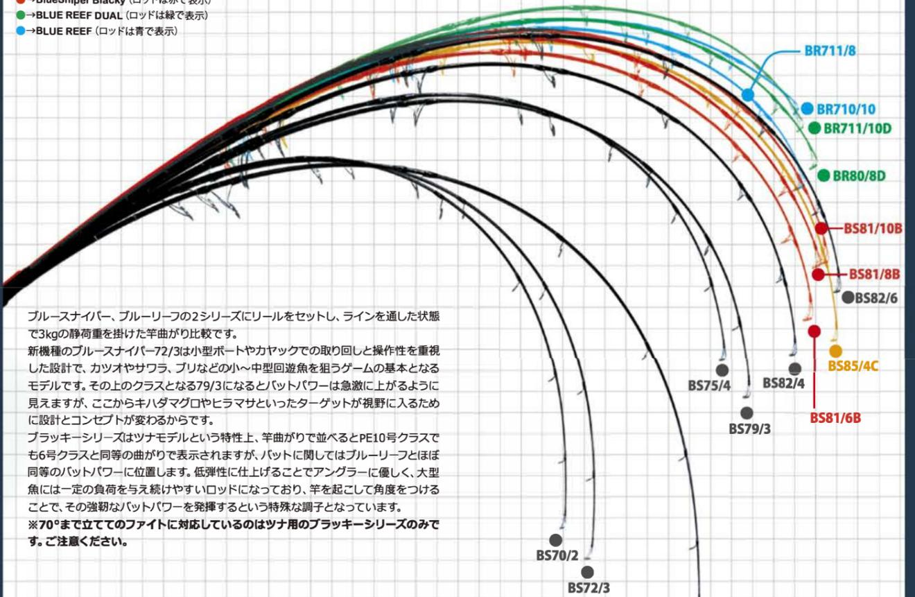
ブルースナイパー、ブルーリーフの2シリーズにリールをセットし、ラインを通した状態で3kgの静荷重を掛けた竿曲がり比較です。新機種のブルースナイパー72/3は小型ボートやカヤックでの取り回しと操作性を重視した設計で、カツオやサワラ、ブリなどの小〜中型回遊魚を狙うゲームの基本となるモデルです。その上のクラスとなる79/3になるとバットパワーは急激に上がるように見えますが、ここからキハダマグロやヒラマサといったターゲットが視野に入るために設計とコンセプトが変わるからです。ブラックーシリーズはツナモデルという特性上、竿曲がりと比べるとPE10号クラスでも6号クラスと同等の曲がりで見えますが、バットに関してはブルーリーフとほぼ同等のバットパワーに位置します。低弾性に仕上げることでアングラーに優しく、大型魚には一定の負荷を与え続けやすいロッドになっており、竿を起して角度をつけることで、その強靭なバットパワーを発揮するという特殊な調子となっています。※70°まで立ててのファイトに対応しているのはツナ用のブラックーシリーズのみです。ご注意ください。
