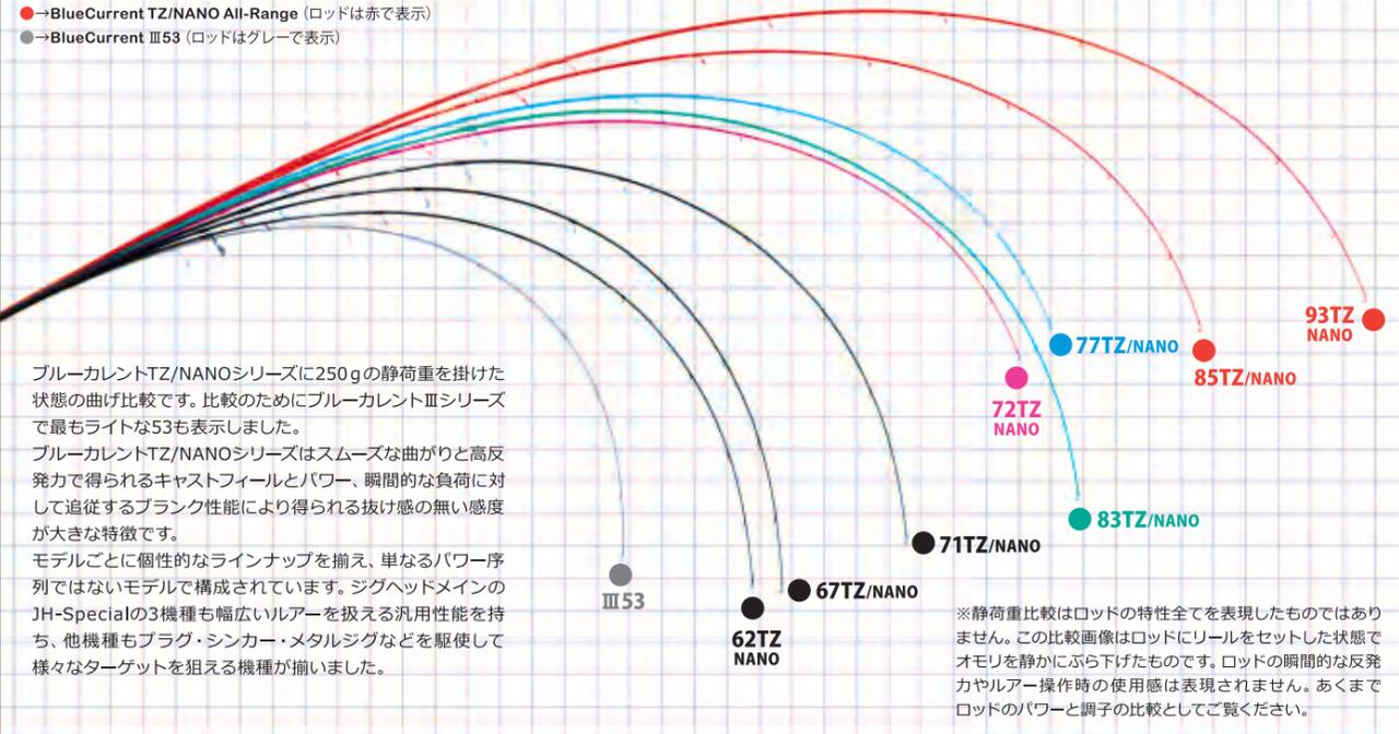
ブルーカレントTZ/NANOシリーズに250gの静荷重を掛けた状態の曲げ比較です。比較のためにブルーカレントIIIシリーズで最もライトな53も表示しました。ブルーカレントTZ/NANOシリーズはスムーズな曲がりと高反発力で得られるキャストフィールとパワー、瞬間的な負荷に対して追従するブランク性能により得られる抜け感の無い感度が大きな特徴です。モデルごとに個性的なラインナップを揃え、単なるパワー序列ではないモデルで構成されています。ジグヘッドメインのJH-Specialの3機種も幅広いルアーを扱える汎用性能を持ち、他機種もプラグ・シンカー・メタルジグなどを駆使して様々なターゲットを狙える機種が揃いました。
